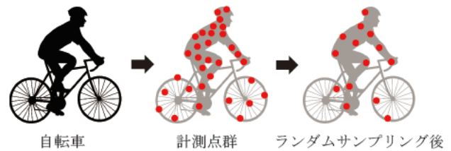
図 2 自転車から計測される点群とランダムサンプリング後の点群.
